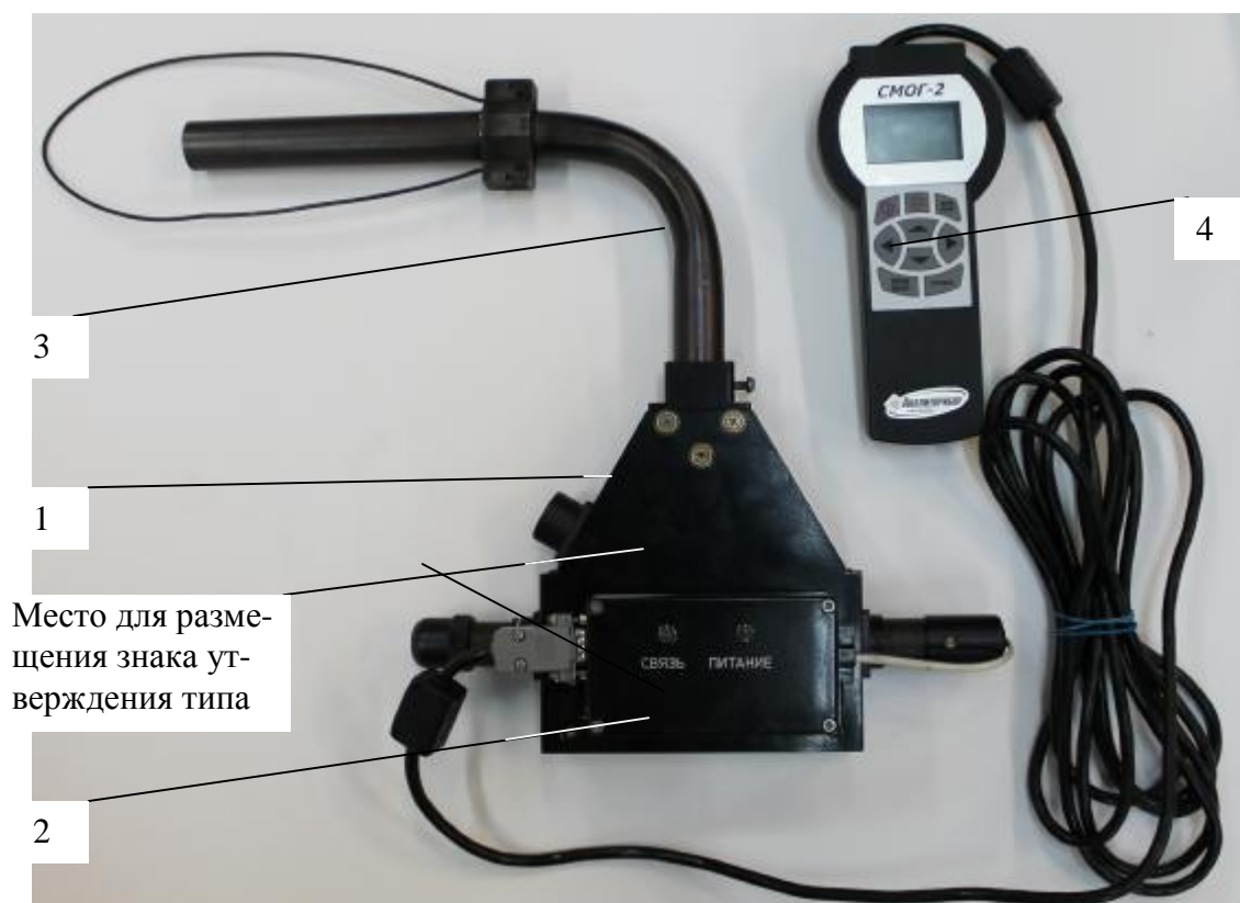
1 - измерительная камера; 2 - БОИ; 3 - пробозаборник; 4 - БПИ
