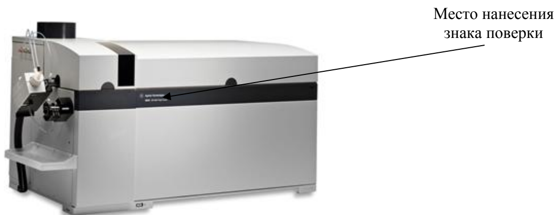
Рисунок 2 - Общий вид масс-спектрометра с индуктивно-связанной плазмой 8800 Triple Quad
