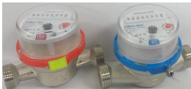
Рисунок 2 - Общий вид счетчиков, имеющих специальное крепление счётного механизма к корпусу с помощью разъёмного кольца с пломбой или пломбирующей наклейкой
