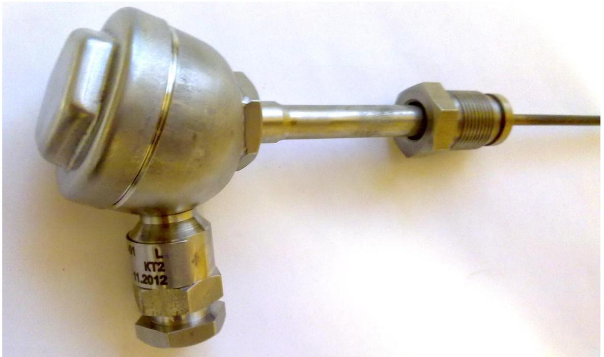
Рисунок 3 – Преобразователь термоэлектрический ТХК-12
