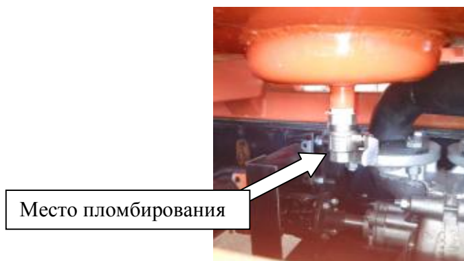
Рисунок 5 – Кран слива отстоя из АТЗ
