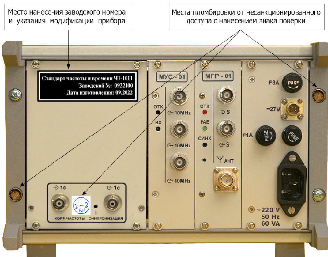
Рисунок 2 – Схема пломбировки от несанкционированного доступа, обозначение мест нанесения знака поверки и заводского номера стандарта
