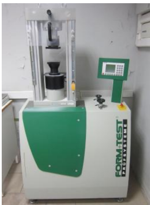
Рис. 1. Общий вид пресса испытательного MEGA 110-200 D
