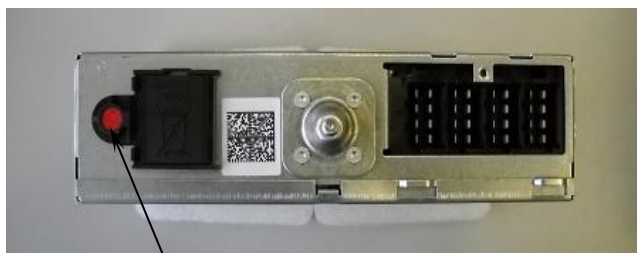
Рисунок 2 Пломба батарейного отсека
