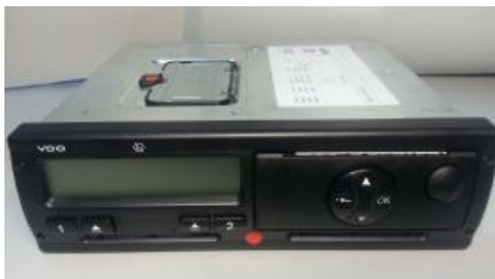
Рисунок.1 Общий вид тахографа автомобильного электронного DTСO 3283.
