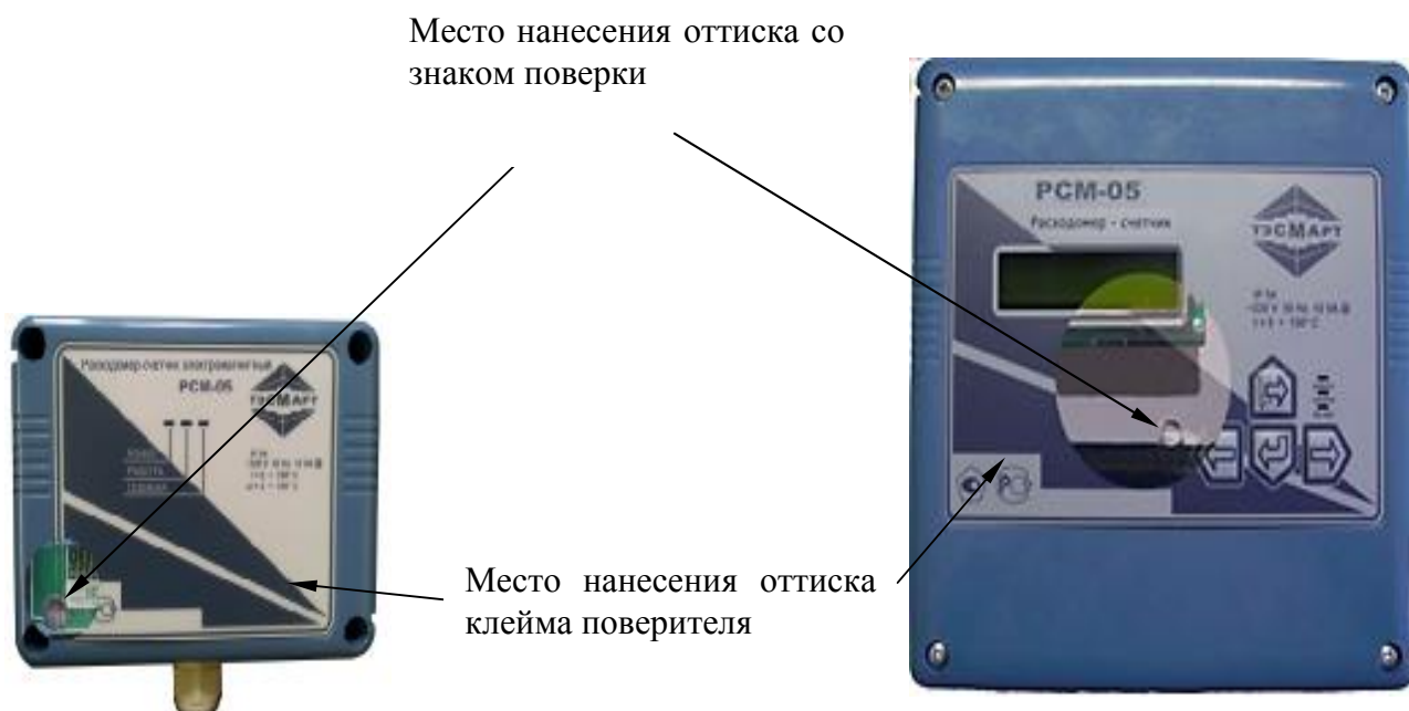
Рисунок 6. Места нанесения оттиска клейма поверителя для РСМ-05.03(ТЭСМАРТ), РСМ-05.03(ТЭСМАРТ-А), РСМ-05.05(ТЭСМАРТ), РСМ-05.05(ТЭСМАРТ-А), РСМ-05.07 (ТЭСМАРТ), РСМ-05.07(ТЭСМАРТ-А), РСМ-05.05(ТЭСМАРТ-П), РСМ-05.05(ТЭСМАРТ-ПА), РСМ-05.05 (ТЭСМАРТ-Э).
