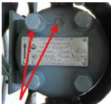
Р и с у н о к 2 – Схема пломбировки счётчика жидкости колонок топливораздаточных переносных с ручным приводом КПП-40РП.
