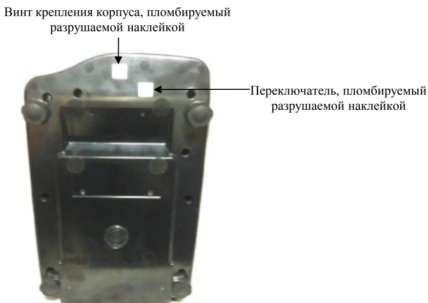
Рисунок 2 - Схема пломбировки весов от несанкционированного доступа.
