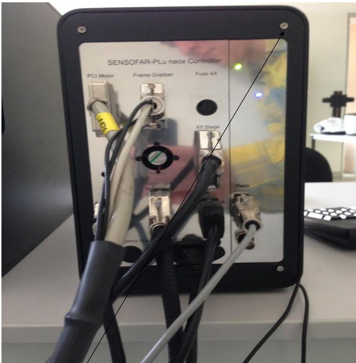
- место пломбировки от несанкционированного доступа Рисунок 2 – Общий вид профилометра Neox. Вид сзади.
