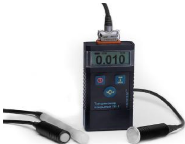
Рисунок 1 – Внешний вид блока обработки информации и преобразователи
