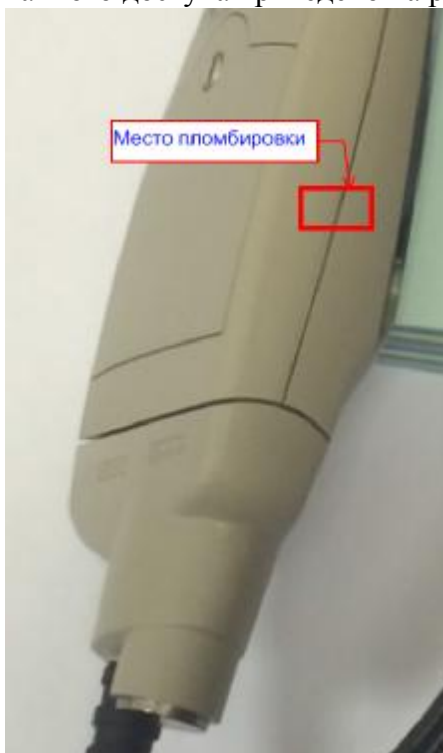
Рисунок 2 - Схема пломбировки от несанкционированного доступа
