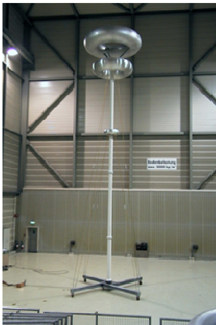
Рисунок 1. Внешний вид делителя импульсного напряжения емкостной CS 2000-420
