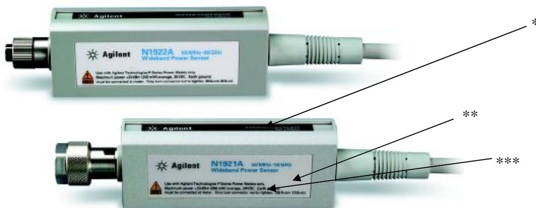
Рисунок 1 – Вид преобразователей измерительных N1921A и N1922A
