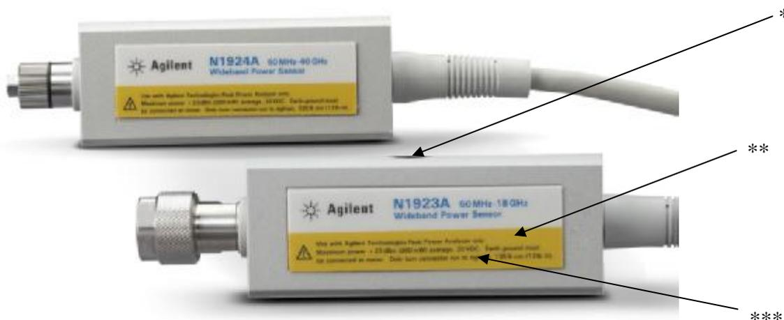
Рисунок 2 – Вид преобразователей измерительных N1923A и N1924A
