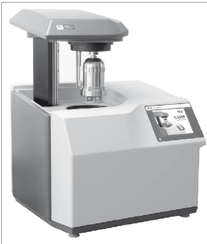
Рис.1. Внешний вид калориметра бомбового С 6000 глобальный стандарт/изопериболический
