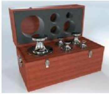
Рисунок 1 – Общий вид набора гирь с номинальной массой от 1 кг до 10 кг
