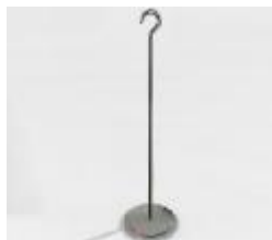
Рисунок 7 – Общий вид гирь в форме диска с крюком
