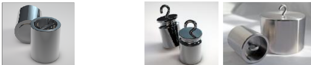
Рисунок 6 – Общий вид гирь в форме цилиндра с рукоятью (слева) и с крюком (справа)
