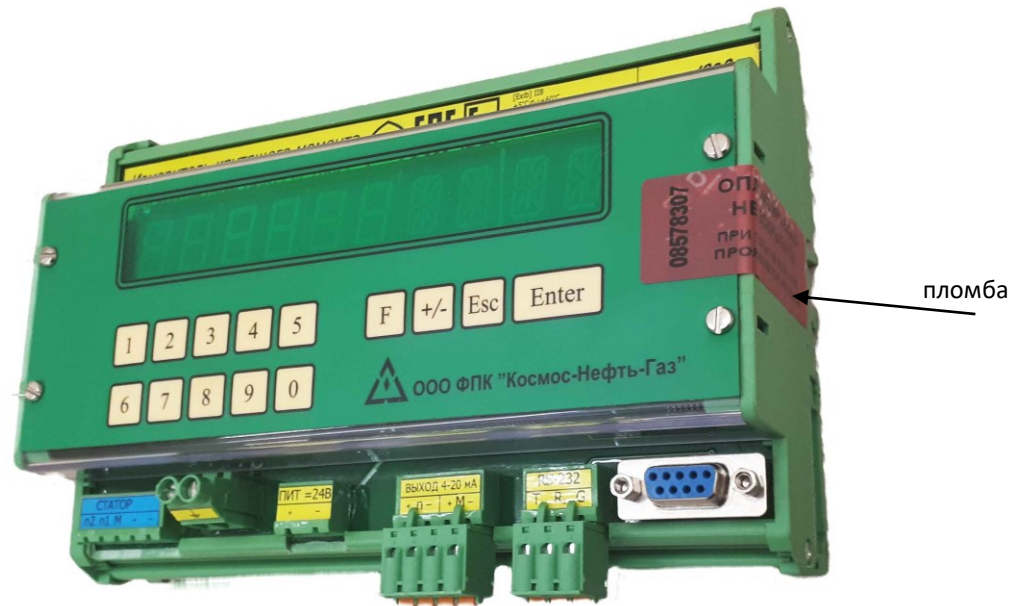
Рисунок 4 – Схема пломбировки блока обработки от несанкционированного доступа
