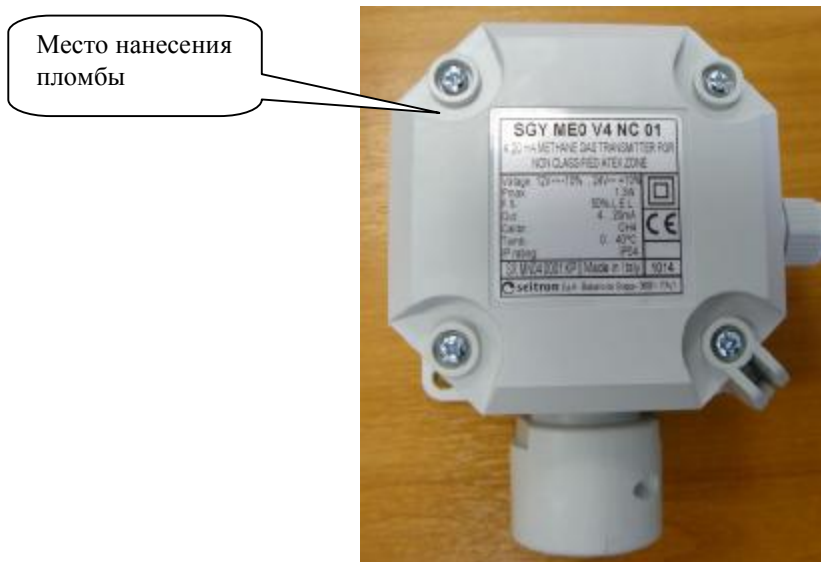
Рисунок 4 – Схема пломбирования сигнализаторов загазованности SGY, SGW
