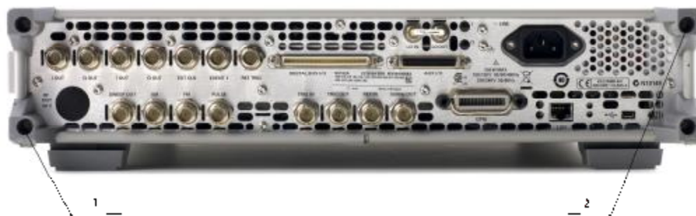
Рисунок 2 – Схема пломбировки генераторов от несанкционированного доступа, где 1; 2 – места для нанесения оттисков клейм.
