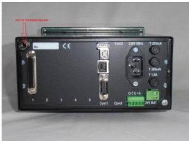
а – задняя панель вычислителя – пломбирование винта крепления задней панели
