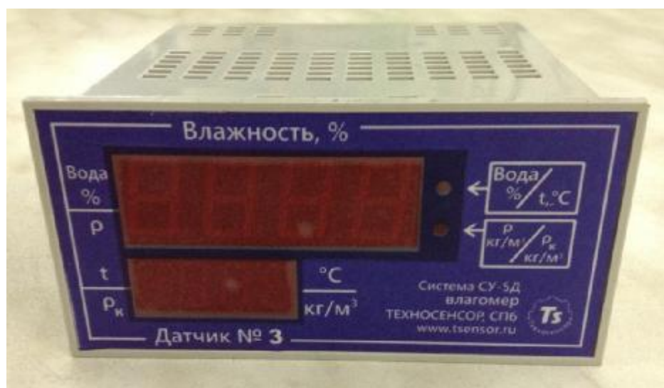
Рисунок 3 - Индикатор ОВЕН СМИ1 измерителя влажности ДЖС-7В Систем измерительных СУ-5Д
