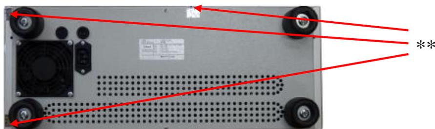
\*\* - места пломбировки от несанкционированного доступа
