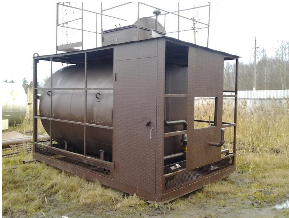
Рисунок 1 – Резервуары стальные горизонтальные для нефтепродуктов РГС (тип РГС-10)
