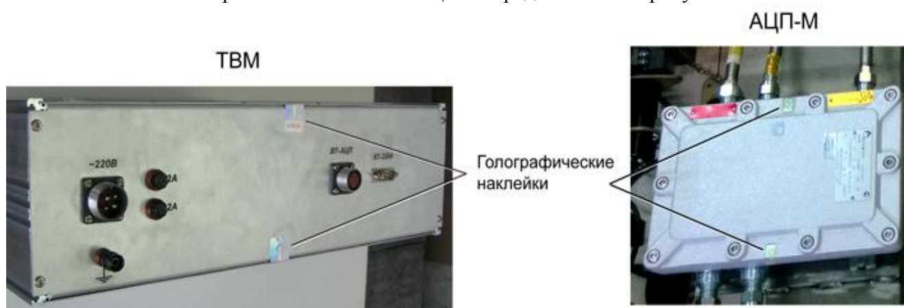
Рисунок 3 - Схема пломбировки ТВМ и блока АЦП-М
