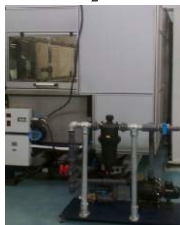
Рисунок 1 – Общий вид установок. На рисунке 1 цифрами обозначены: 1 – электрический шкаф; 2 – операторский пульт; 3 - водный контейнер и ультразвуковые сканирующие головки; 4 - водный контур
