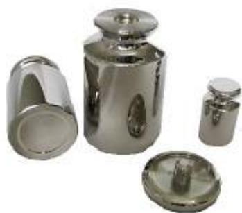
Рисунок 4.Гири с отвинчивающейся головкой
