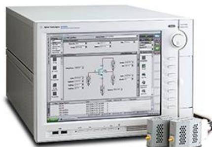
Приборы имеют встроенный компьютер, работающий на платформе MS Windows 7. Компьютер оснащен встроенным накопителем на жестком диске, приводом DVD, интерфейсами GPIB, USB, LAN. Управление анализаторами осуществляется с помощью сенсорного дисплея или подключаемых клавиатуры и манипулятора типа «мышь».
