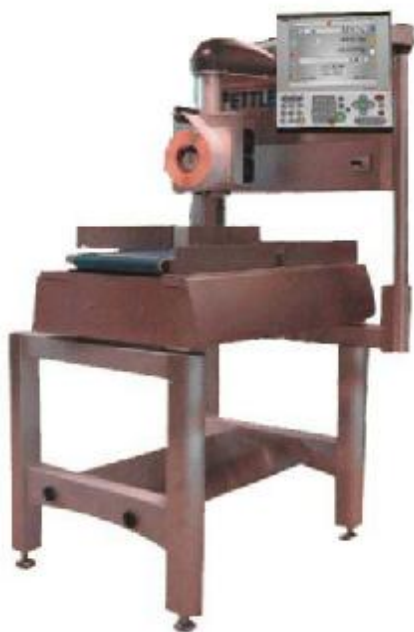
Рисунок 2 – Модификация весов с двумя транспортёрами
