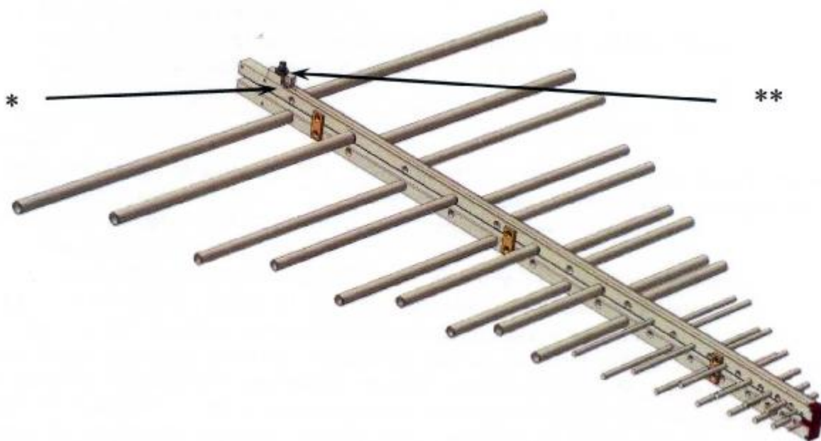
Рисунок 3 – Места пломбировки от несанкционированного доступа и нанесения знаков утверждения типа
