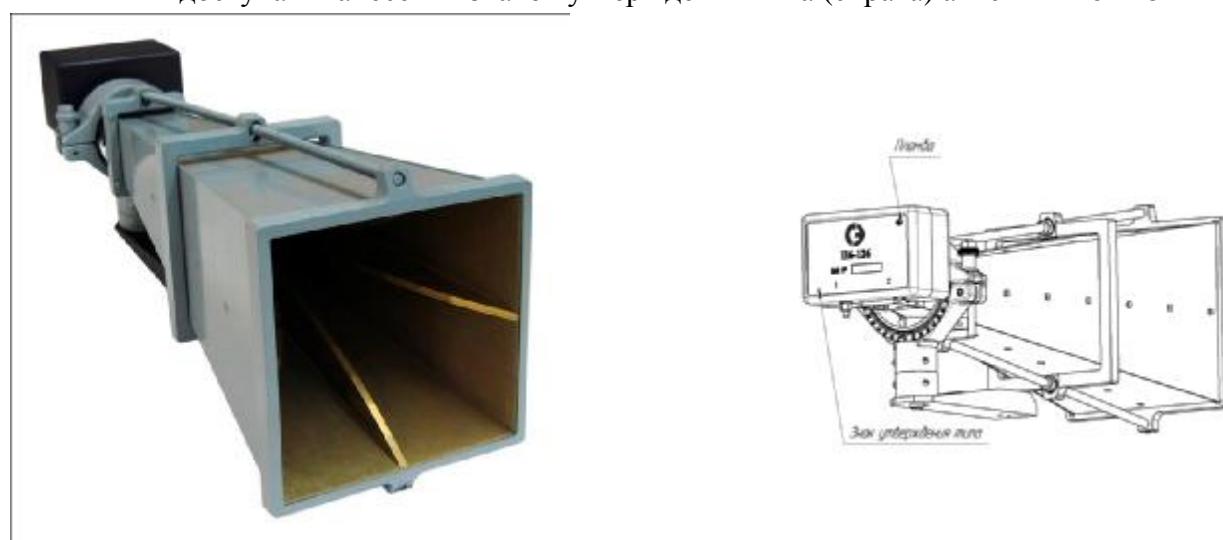
Рисунок 3 – Фотография внешнего вида (слева), места пломбировки от несанкционированного доступа и нанесения знаков утверждения типа (справа) антенны ПБ-126
