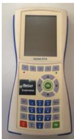
Рис.1 Анализатор теплофизических параметров QL30 Model ISOMET 2114
