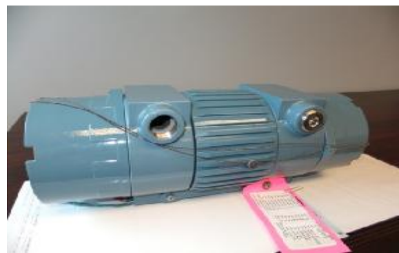
Рисунок 3 – Место пломбировки трансмиттера расходомера ультразвукового LEFM 280CiRN-M
