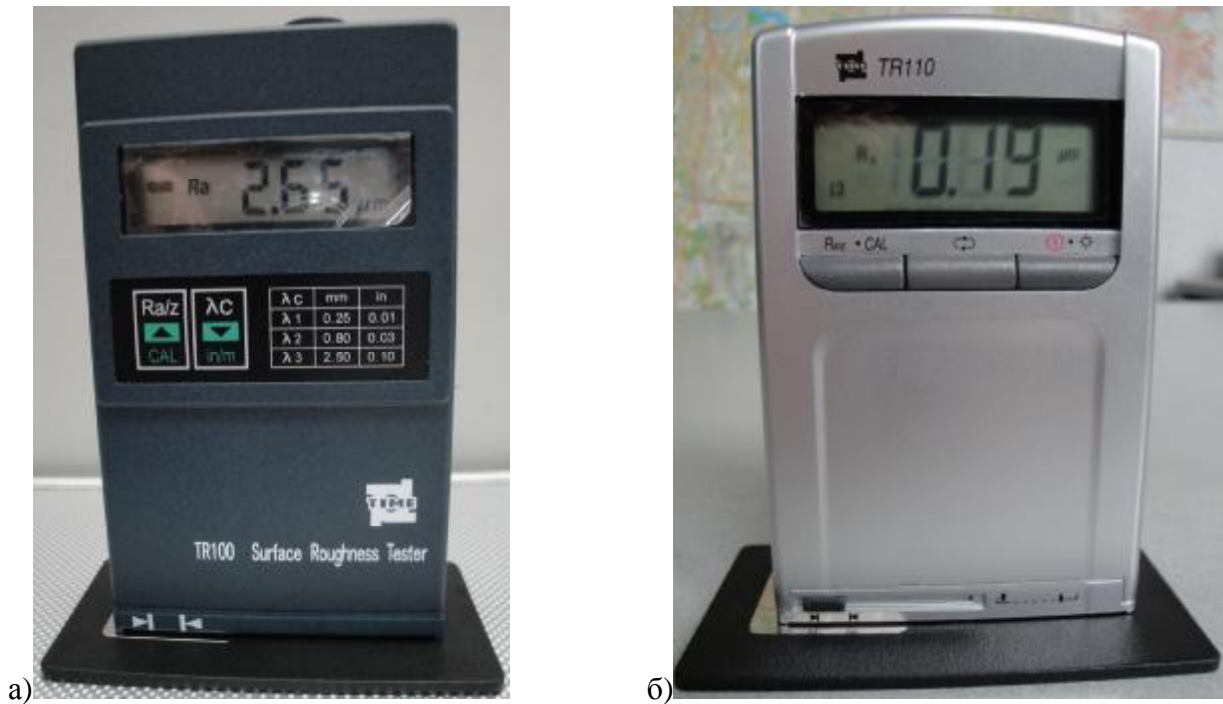
Рисунок 1 – Общий вид прибора серии TR100: а - TR100, б - TR110
