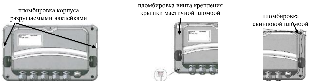
Рисунок 5 — Схема пломбировки приборов i 20, i 30, i 35, i 40-SS
