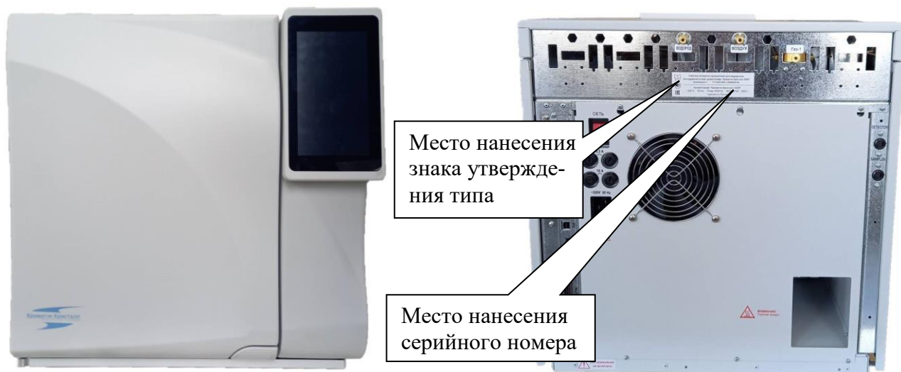
Рисунок 1. Общий вид, место нанесения знака утверждения типа и серийного номера комплекса аппаратно-программного для медицинских исследований на базе хроматографа «Хроматэк – Кристалл 5000» – исполнение 1 (со встроенной панелью управления).
