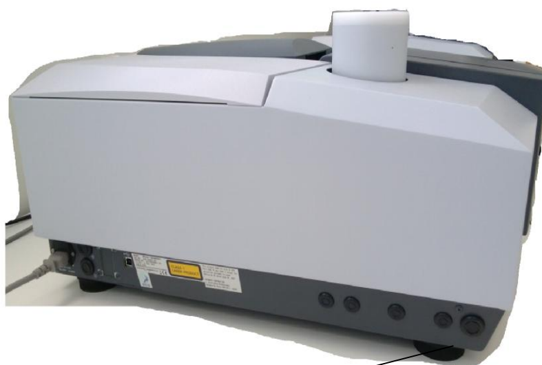
Рисунок 2 - Фурье - спектрофотометр инфракрасный IRTracer-100 (вид сбоку) с обозначением места пломбирования
