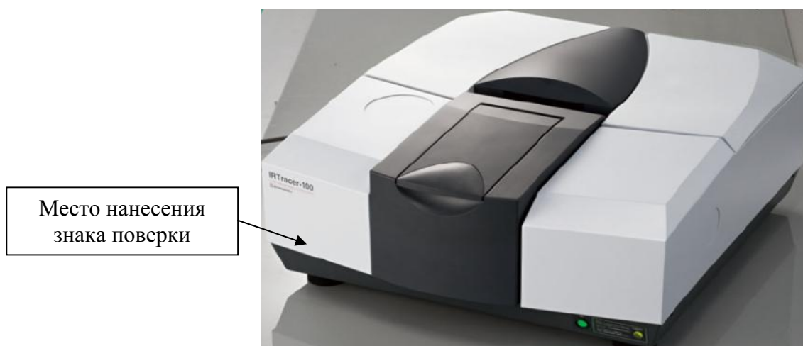
Рисунок 1 - Общий вид Фурье - спектрофотометра инфракрасного IRTracer-100 с обозначением места маркировки
