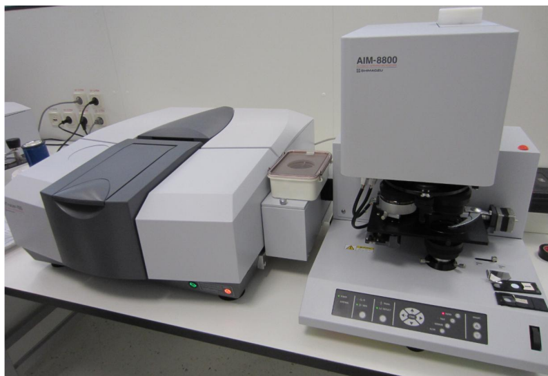
Рисунок 4 - Общий вид Фурье - спектрофотометра инфракрасного IRTracer-100 с инфракрасным микроскопом AIM-8800
