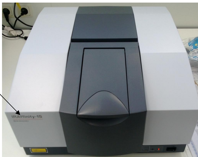
Рисунок 5 - Общий вид Фурье - спектрофотометра инфракрасного IRAffinity-1S с обозначением места маркировки
