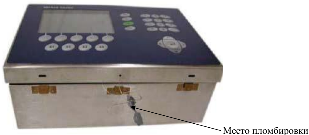
Рисунок 3 - Схема пломбировки настольного исполнения терминалов, обозначение мест нанесения знака поверки
