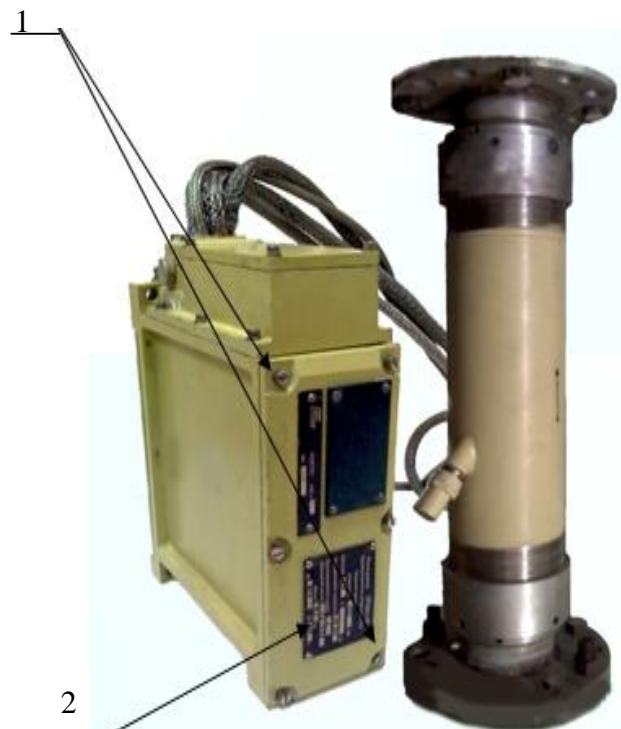
Рисунок 2- Внешний вид расходомера с преобразователем первичным угловым (ППУ)
