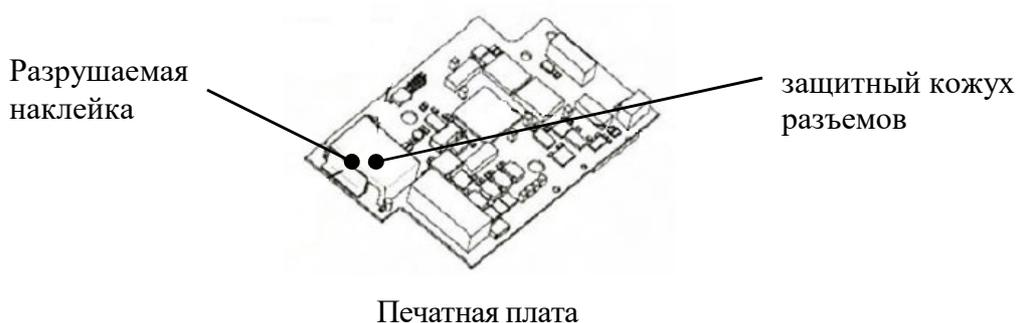
Рисунок 7 — Схема пломбировки от несанкционированного доступа
