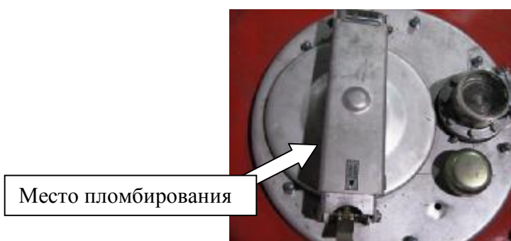
Рисунок 5 - Запорный механизм крышки заливной горловины АТЗ
