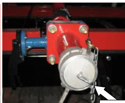
Рисунок 7 – Ручка открывания технологического отсека, или заглушка открывания трубопровода слива топлива из АТЗ (в зависимости от конструктивного исполнения)
