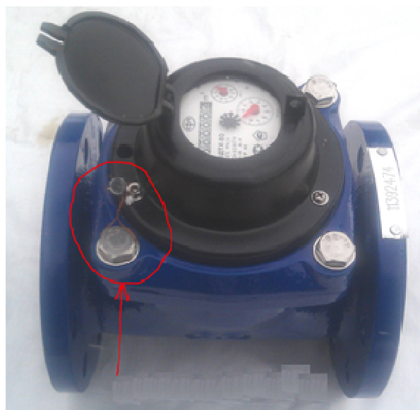
Рисунок 2 – Схема пломбировки от несанкционированного доступа, обозначение места нанесения знака поверки счетчиков холодной воды крыльчатых ВДХ-М, ВДХ-ИМ, турбинных ВДТХ-М, ВДТХ-ИМ, холодной и горячей воды крыльчатых ВДГ-М, ВДГ-ИМ, турбинных ВДТГ-М, ВДТГ-ИМ
