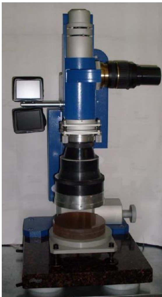
Рисунок 1 – Общий вид интерферометров OptoPI-60/120
