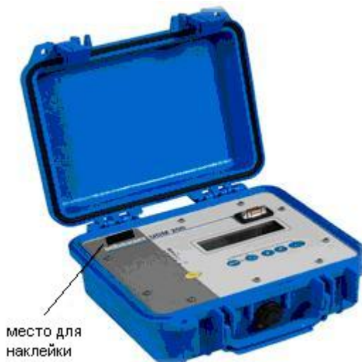
Рисунок 2 - Схема пломбирования расходомеров ультразвуковых накладных UDM 200
