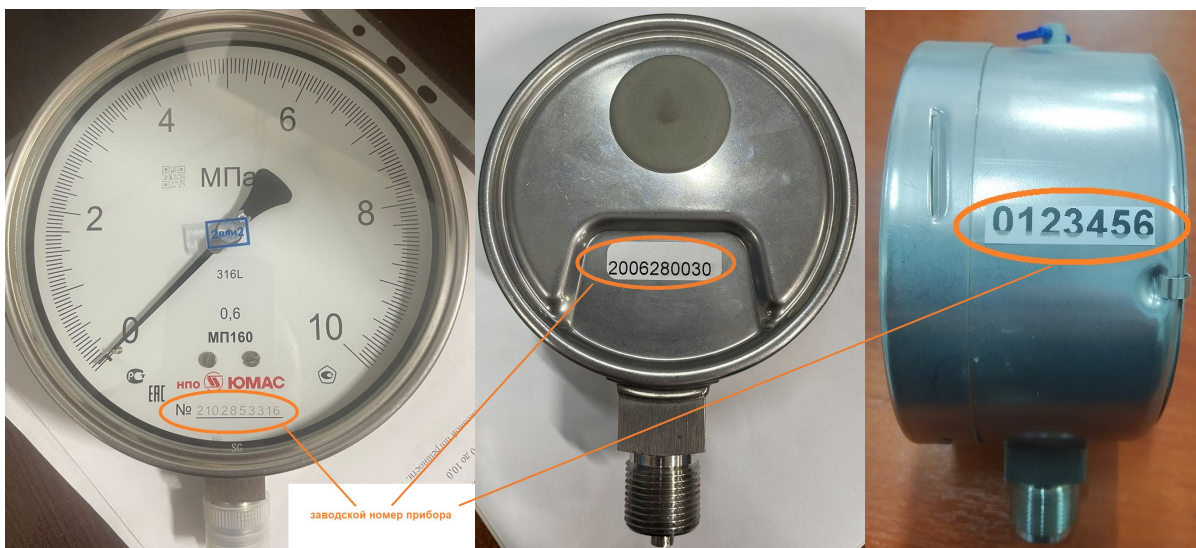
Рисунок 13 – Места нанесения заводского номера
