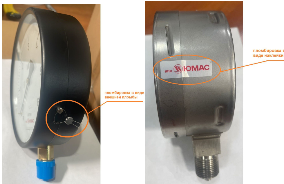
Рисунок 15 – Места установки пломбировки корпуса прибора
