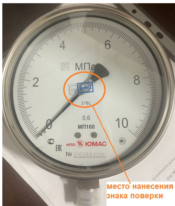
Рисунок 14 – Места нанесения знака поверки
