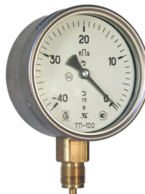
Рисунок 6 – Общий вид вакуумметров показывающих ТП
