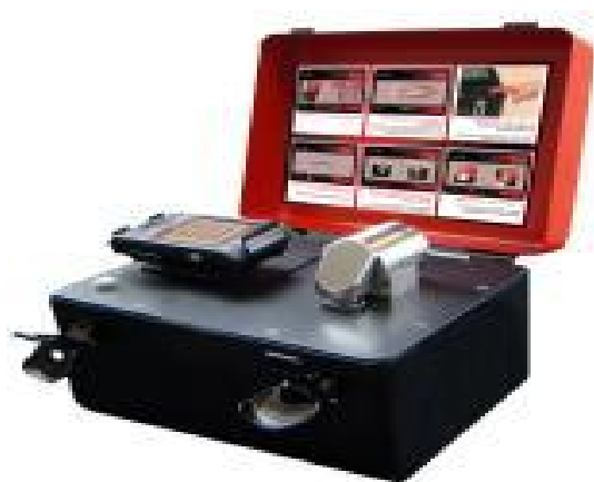
Рисунок 4. Внешний вид фурье-спектрометра 4500 Series FTIR.
