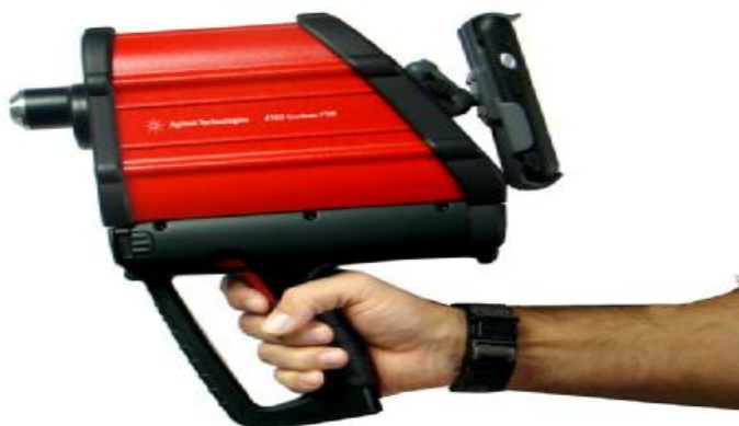
Рисунок 1. Внешний вид фурье-спектрометра 4100 ExoScan FTIR.
