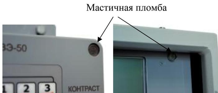
Рисунок 4 – Схема пломбировки прибора
