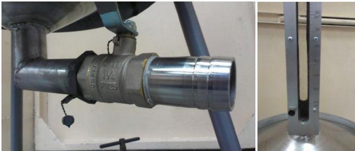
Рисунок 2 – Места пломбирования мерника металлического эталонного 1-го разряда М1р-60
