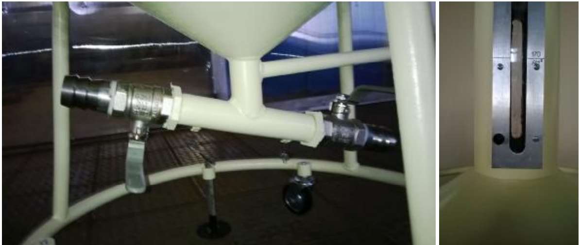
Рисунок 2 – Места пломбирования мерников металлических эталонных 1-го разряда М1р-170
