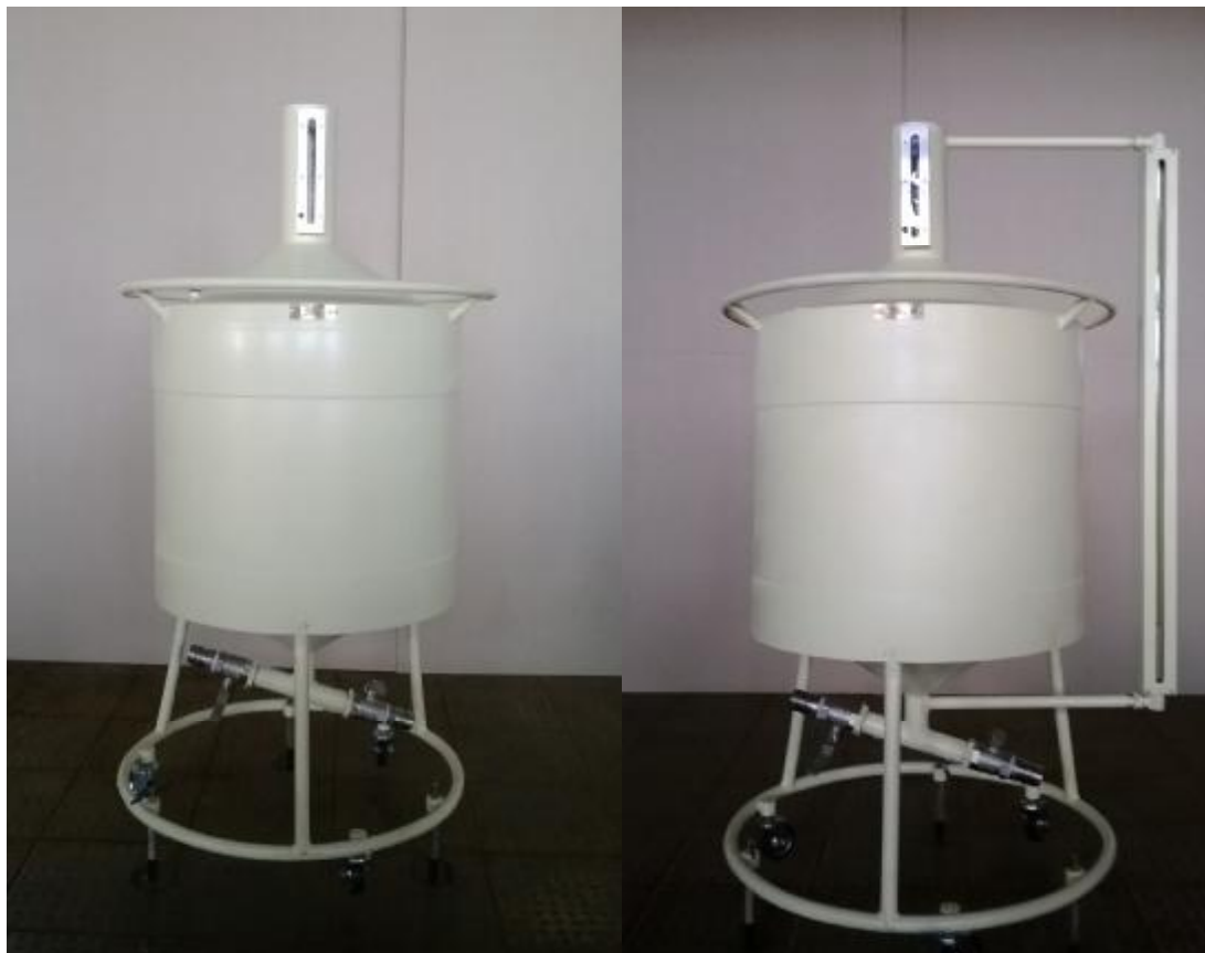
Рисунок 1 – Общий вид мерников металлических эталонных 1-го разряда М1р-170
